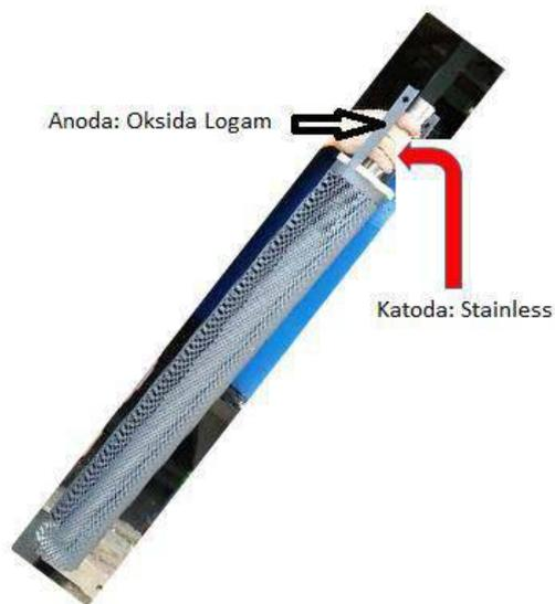
Susunan anoda – katoda yang terangkai dalam sel elektrokatalitik
